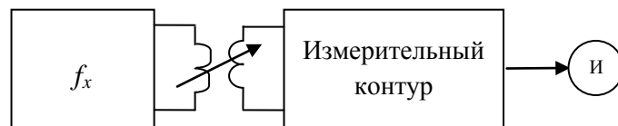
Рис. 9.3. К измерению частоты резонансным методом
