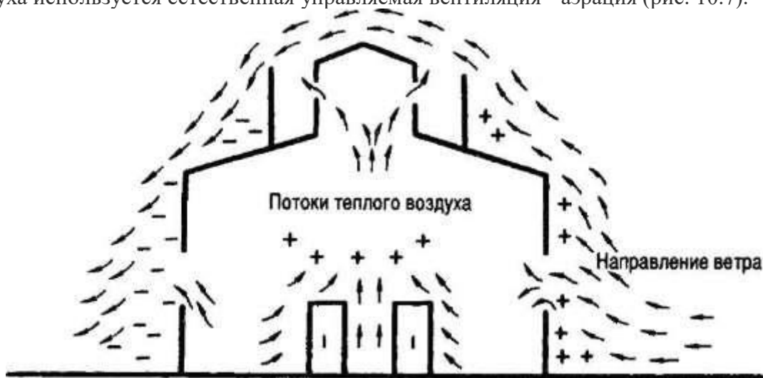
Рис. 10.7. Аэрация в помещении
