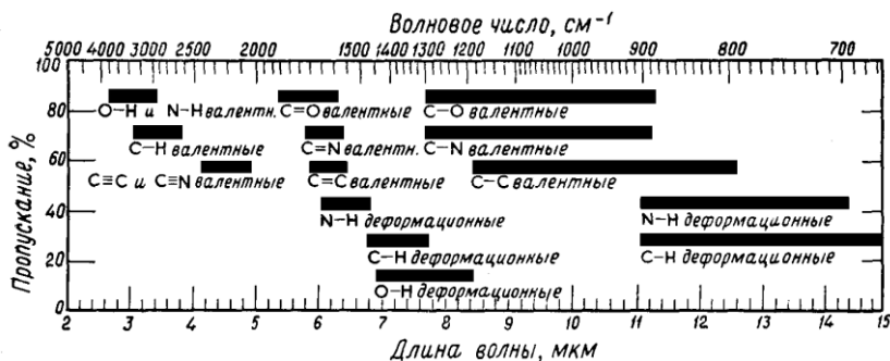
Рис. 6.25. Схема взаимного расположения сигналов разных связей, применяемая при интерпретации ИК-спектров
