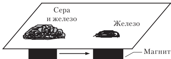
Рис. 1.3. Разделение порошков железа и серы магнитом
