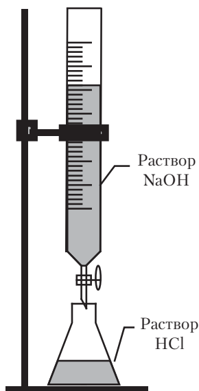
Рис. 3.1. Титрование кислоты щелочью
