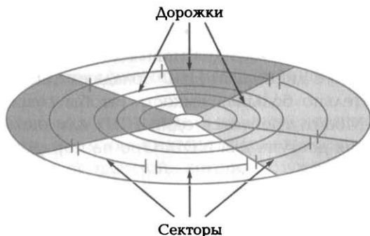
Рис. 3.3. Разбиение магнитного диска на дорожки и сектора при форматировании
