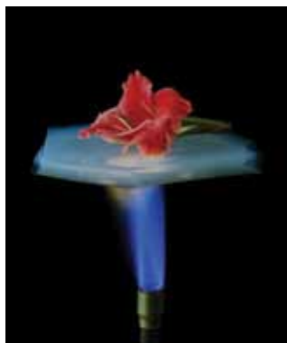
Рис. 20.10. Современный теплоизолирующий материал. Внизу — газовая горелка
